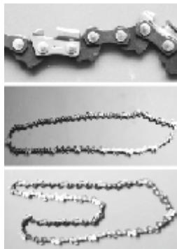
имеет хорошую прочность, остро заточенные режущие зубья. На поверхности цепи указано направление движения. При каждом использовании цепи необходимо обращать внимание на направление вращения цепи.
