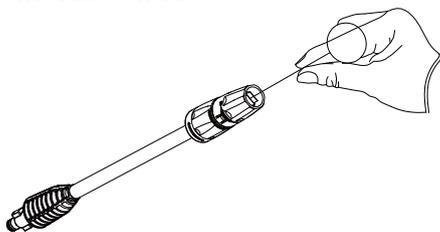
Когда сопло засоряется, создаётся избыточное давление, что может вызвать скачок напряжения в аппарате. В комплект поставки входит игла для прочистки сопла, производите очистку по мере необходимости.
