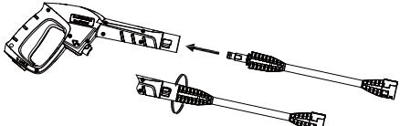
2. Для прикрепления распылительного сопла(H) вставьте его в удлинитель(G), и приложите достаточное усилие при нажатии до характерного щелчка. Проверьте надежную фиксацию сопла.
