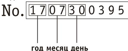
Дата изготовления изделия зашифрована в серийном номере, напечатанном на корпусе инструмента. Первые 2 цифры обозначают год выпуска, следующие 2 цифры – месяц и следующие 2 цифры - день.
