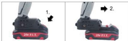
Чтобы извлечь аккумуляторную батарею, нажмите на кнопку разблокировки и извлеките аккумулятор из электроинструмента.
